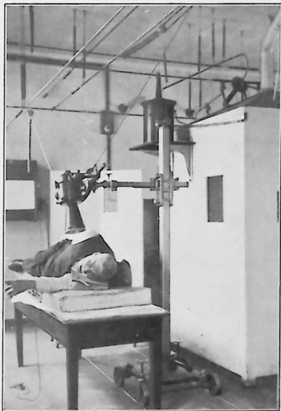
FIG. 19. — Salle de Radiographie du Service d'Electro-Radiologie de l'Hôpital Saint-Louis, établie sur les plans du Dr J. Belot. On voit la table, le pied-support Belot-Gaiffe) avec sa voie de roulement, les trolley tubulaires, la cabine de protection et de commande, avec sa fenêtre. Un second poste se trouve symétriquement de l'autre côté de la cabine.
