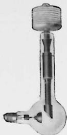
FIG. 24. — Tube Coolidge pour radiographie dentaire.
