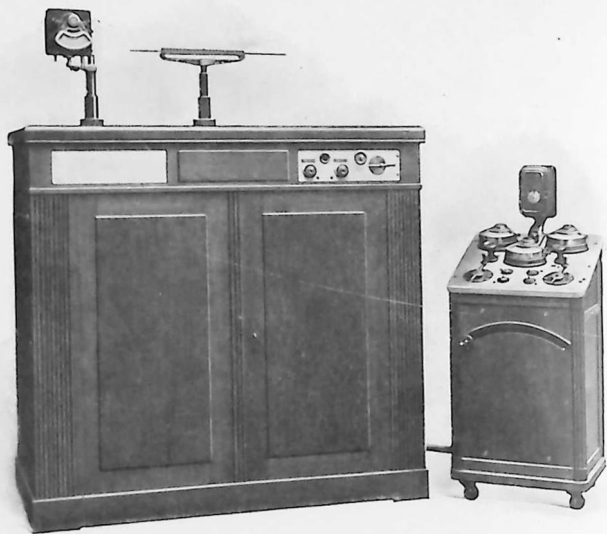
FIG. 13. — Commutateur tournant avec pupitre de commande. (Modèle Gaiffe-Gallot-Pilon.)
