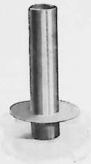
FIG. 29. — Lunette de centrage en laiton.
