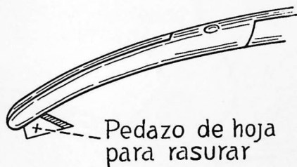
Fig. 107.—Criptótomo simple, pero eficaz, hecho con un pedazo de hoja de resurar.
