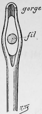
Fig. 87. — Aiguille à talon évidé et à chas ogival ; le fil ne reste pas au milieu du chas ; il va se coincer dans la partie étroite postérieure : dès lors il ne pourra plus défilier.
