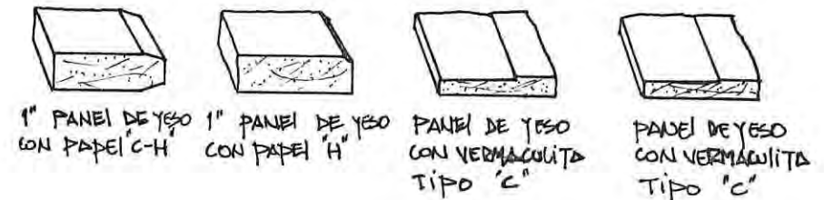
Fig.52. Materiales constituyente de tabiques resistente al fuego.
