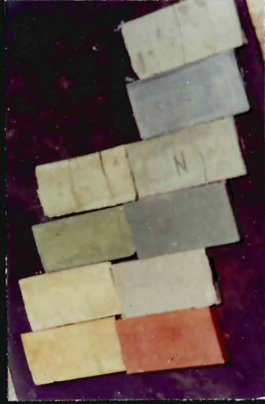
Diferencia de color entre probetas á pasta de cemento pigmentadas con 5% de tierra de color y otras con 5% de pigmentos sintéticos.
